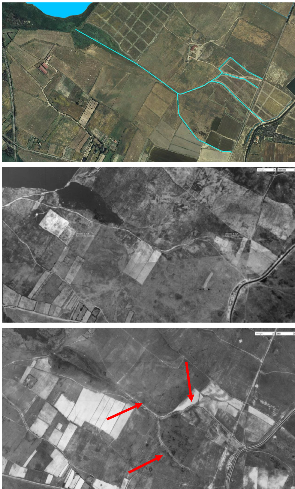
Figura 4 – Confronto fotografico di alcuni canali di dreno che scaricano sullo stagno di Pauli Maiori. La prima è del 2010 (in ciano le aste), la seconda è del 1954 e la terza del 1968.
